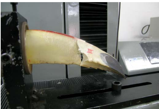
Fig.5. Fratura do bico nº 1 em sua porção central, quando submetido à tração de 270,4 N, com deslocamento de 22,59mm.
