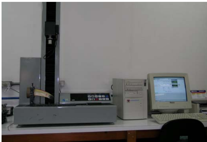
Fig.3. Esquema demonstrando a fixação do bico ao cabeçote móvel do dinamômetro, cujos dados obtidos eram transferidos ao computador ao lado por meio de programa computacional especializado.
